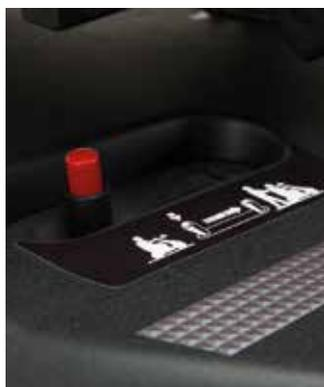
**Leva di sblocco motore**
